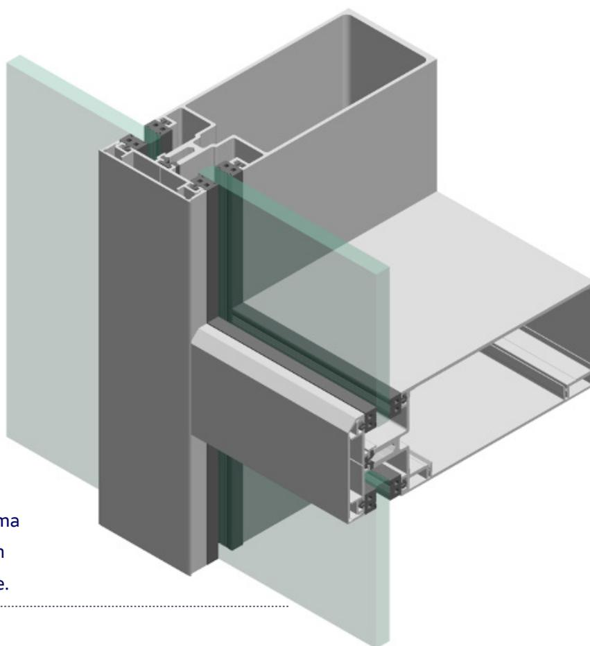
Detalhe do sistema de montagem em formato de grade.
